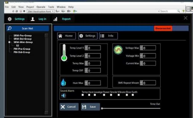
تمامی دیتالاگرها قابلیت اتصال به شبکه با استاندارد مدباس را دارند و میتوانند نرم افزار تمامی پارامترهای دما رطوبت و فشار را مشاهده و ذخیره کند و خروجی پارامتر ها را میتوان در قالب گراف یا اکسل مشاهده کرد همچنین میتوان تمامی دیتالاگر ها را تحت شبکه Web درگوشی یا تبلت به صورت آنلاین مشاهده کرد
